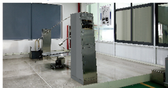
防水测试 Rain Test
